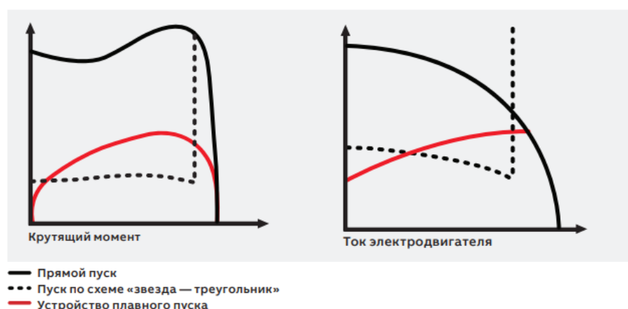
Рисунок 3 - Графики изменения пускового тока и крутящего момента в зависимости от способа пуска электродвигателя.
